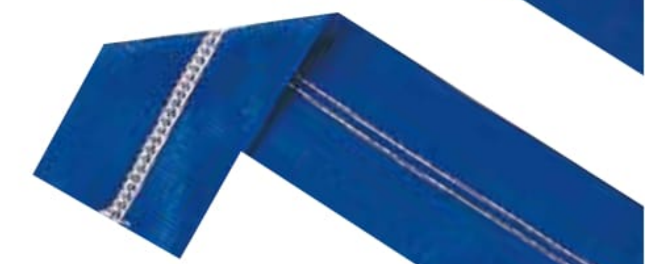
Recubrimiento de 2 agujas - 3 mm
